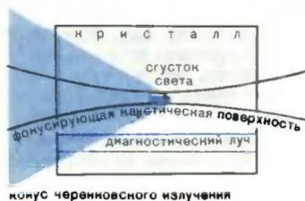
Схема эксперимента по получению и наблюдению черенковского излучения от светового импульса, проходящего через электрооптическую среду.
