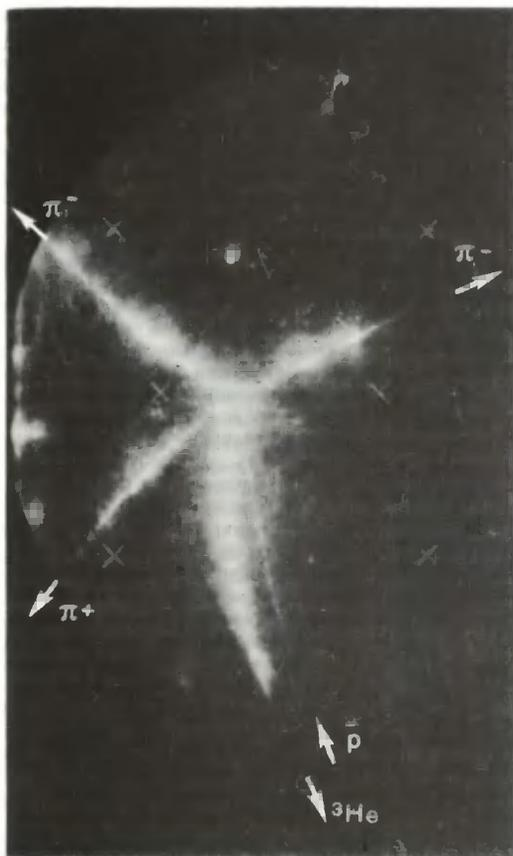
Фотография типичного события — образования ядра  ${}^3\text{He}$  в реакции аннигиляции  $\bar{p} + {}^4\text{He} \rightarrow {}^3\text{He} + \pi^+ + \pi^-$ . Стрелками показаны треки начального антипротона  $\bar{p}$  и продуктов реакции  ${}^3\text{He}$ ,  $\pi^-$ ,  $\pi^+$ .
