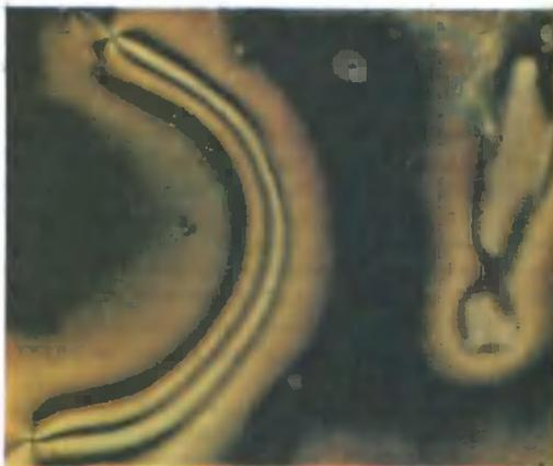
Примеры точечных особенностей в жидких кристаллах. Снимок получен с помощью поляризационного микроскопа в Институте кристаллографии им. А. В. Шубникова АН СССР. Концы темной линии, видимой на снимке, соответствуют точечным особенностям или сечениям нитей.
